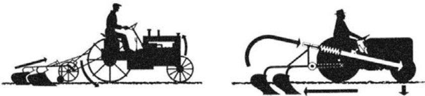
Evolución en la geometría de enganche con sistema Ferguson.
