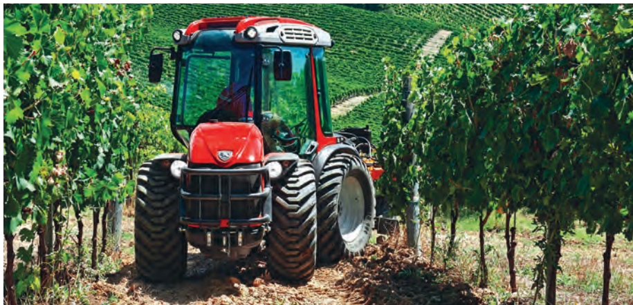
Prototipo de tractor compacto full hybrid que aforra combustible en máis dun 30 %
